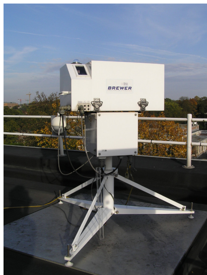
Figuur 2.10. Het Brewer-instrument op het dak van het KMI
