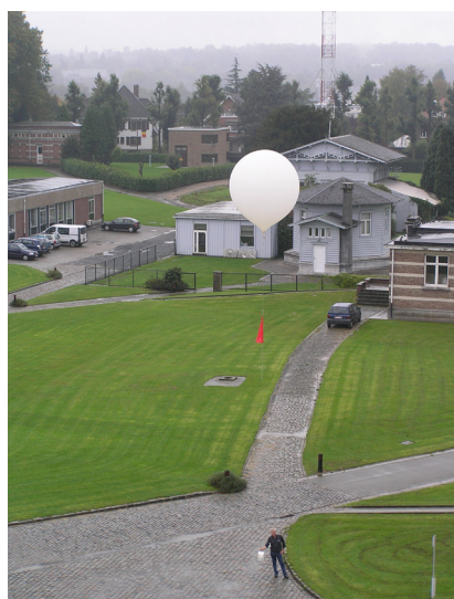
Figuur 2.11. Lancering van een meteorologische ballon met ozonsensor te Ukkel.
